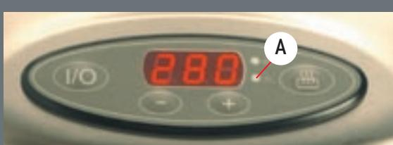
На дисплее панели управления отображается температура пространства с камнями. Для поддержания готовности каменки к эксплуатации эта температура должна составлять не менее 260–280 градусов. Лампочка **A** загорается для индикации режима ожидания "LO". Для регулировки температуры во время ожидания используйте кнопки (-) и (+).
